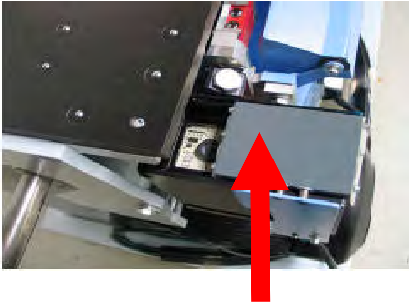
BV – System „Sägeritzsensor“ mit Schutzvorrichtung – montiert am Sägewagen
