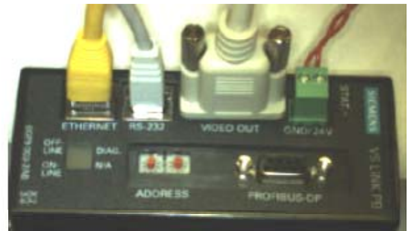
Verschaltetes VS Link des Systems Simatic S7
